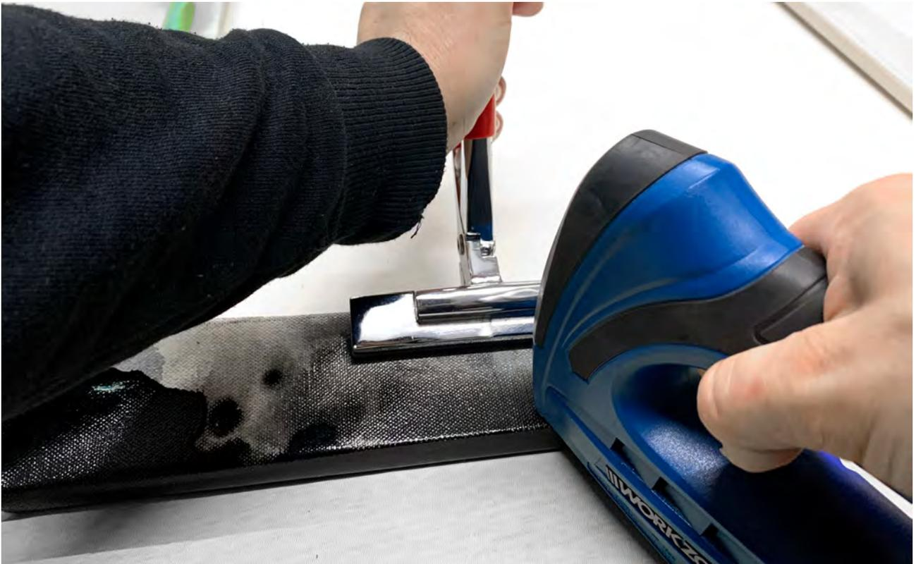
Setzen Sie nun vorsichtig die Spannzange in der Mitte an (direkt neben dem Zwischenstück), an. Greifen Sie den Stoff in der Innenseite des Rahmens und ziehen Sie das Gewebe, unter Nutzung der Hebelwirkung, leicht über den Rand. Nur soviel das die vor Ihnen liegende Kante eckig erscheint. Dann fixieren Sie die Leinwand mit zwei Tackerklammern.
